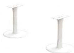
Fusto in tubo di acciaio Ø 100 mm conificato nei lati inferiore e superiore Ø 140 mm; piastra superiore in acciaio per il fissaggio al piano; piantana inferiore in lamiera di acciaio stampato sp. 6 mm Ø 590 mm. Tutto verniciato a polveri epossidiche. Piantana inferiore provvista di guarnizione trasparente.
