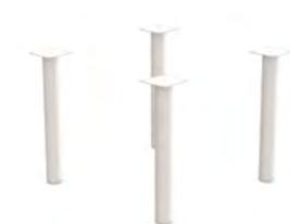
Gambe in tubolare d'acciaio diametro 80 mm, sp. 1,2 mm, con piastra superiore in acciaio sp. 3 mm per fissaggio al piano, verniciate a polveri epossidiche.
