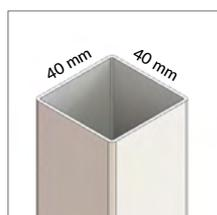
Gamba 01 in tubo di acciaio sezione 40x40 sp. 1,5 mm con staffe laterali in lamiera piegata di acciaio sp. 3 mm.
